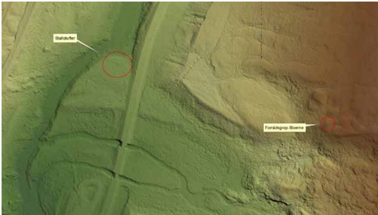
LIDAR-data er en høydeltaljert skanning av terrenget, som genereres ved hjelp av et fly som sender ut en rekke laserpulser mot bakken. LIDAR-data gir dermed grunnlag for å produsere nøyaktige 3D modeller av markoverflaten og terrenget, og er så detaljerte at selv små strukturer i bakken blir synlige.
